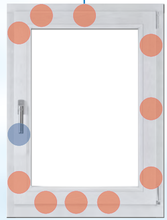
entspr. WK 2 mit abschließbarem Handhebel und Sicherheitsglas
